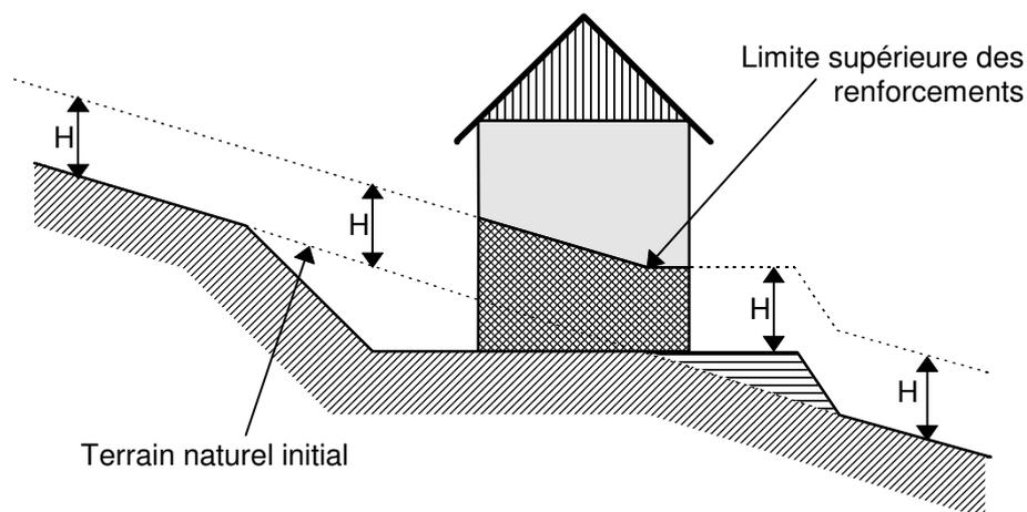
Les règles demandant le respect d'une hauteur minimum par rapport au terrain naturel doivent être respectées en tout point du projet. Dans le cas d'une demande de surélévation, du plancher d'un local par exemple, ceci ne conduit pas nécessairement à un niveau unique de surélévation, notamment lorsque la pente du terrain est forte.
